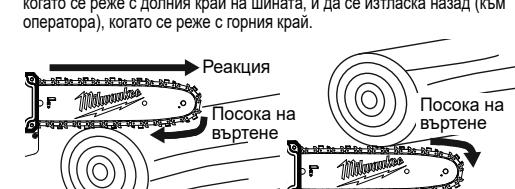
**Заклещване на веригата в прореза**
